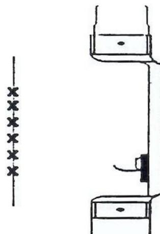
La pression du ressort et l'écartement sont corrects. Cette figure est celle que l'on doit obtenir pour la réussite de ce réglage.
